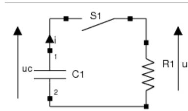
Lorsque le circuit est fermé, on a  $U_c = Ee^{-\frac{t}{\tau}}$  et  $U_r = U_c$  avec  $\tau$  une constante positive.
