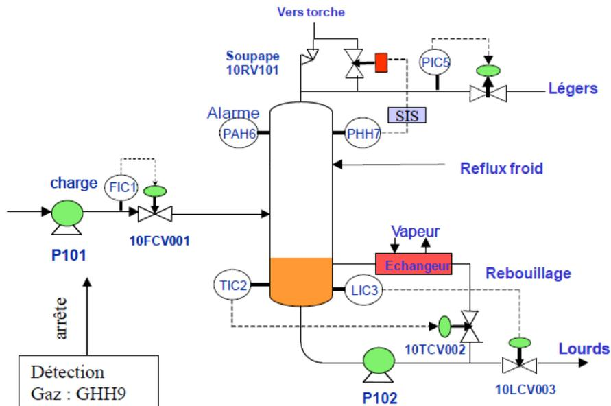
L'installation est une unité de séparation d'hydrocarbure située dans une raffinerie de pétrole brut. La pompe P101 alimente la colonne. La vanne 10FCV001 est une vanne de régulation de débit en entrée de la colonne.
