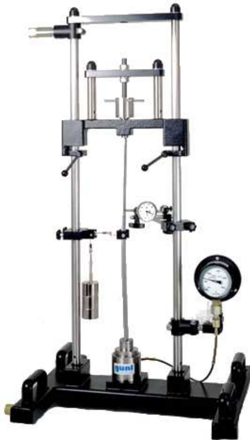
Figure 4.2 – Banc expérimental pour le flambement des poutres (photo)
