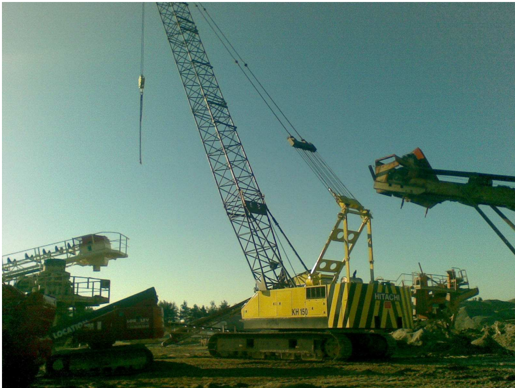
Figure 3.1 – Exemple d'utilisation des structures de type treillis
