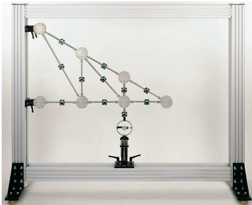
Figure 3.2 – Banc expérimental pour l'analyse de treillis plan (photo)
